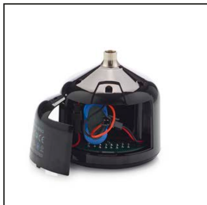
fase 5 : Verwijder de batterijdeur.
