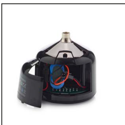
Phase 5 : retirez le cache de la batterie
