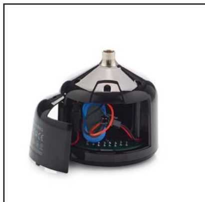
Phase 5 : remove the battery door
